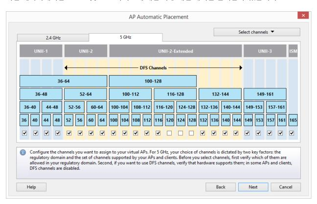
2.4GHz의 경우 11개 채널이 허용되는 규제 도메인의 채널 1-6-11 또는 13개 채널이 허용되는 규제도메인의 1-7-13을 사용하는 것이 좋습니다. 백업 옵션으로 각각 1-4-7-11 및 1-5-9-13을 사용할 수있습니다. 그러나 4개의 20MHz 채널을 사용하는 경우 채널 중첩이 불가피하기 때문에 이러한설정은 절대 권장되지 않습니다. 5GHz의 경우 채널 선택은 규제 도메인과 AP 및 클라이언트가지원하는 채널 세트의 두 가지 주요 요소에 의해 결정됩니다. 채널을 선택하기 전에 먼저 규제도메인에서 허용되는 채널을 확인합니다. 다음으로, DFS 채널을 사용하려면 하드웨어가 이러한채널을 지원하는지 확인합니다. 일부 AP 및 클라이언트에서는 DFS 채널이 비활성화됩니다.
