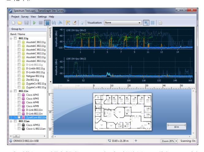
스펙트럼 창은 Wi-Spy와 함께 제공되는 MetaGeek의 스펙트럼 분석 응용 프로그램인 *Chanalyzer*에서 볼 수 있는 것과 유사합니다. 기본적으로 스펙트럼 창은 단일 및 듀얼 대역 Wi-Spy 모델에 대해 각각하나 또는 두 개의 평면 스펙트럼 그래프를 표시합니다.
